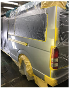
▲板金塗装中の様子。平らにする際には、手での感触も重要な決め手です。また、塗料の調色も大切なポイントになります。
